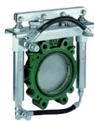
**Robinet-vanne MZ, variante courte avec vérin hydraulique à double effet**
